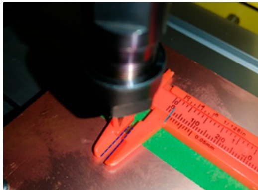
Figura 27, Primera Prueba de Calibración.
