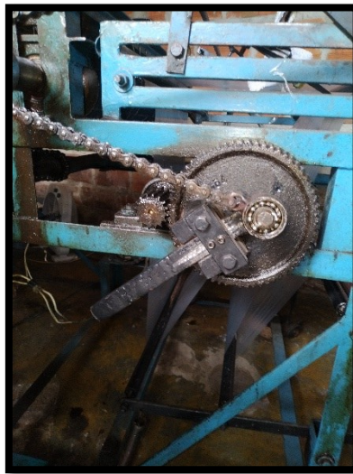
Figura 1- 18: Sistema variador de velocidad.
