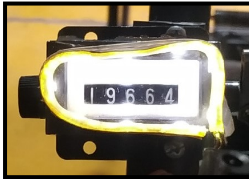
Figura 1- 28: Contador mecánico de 5 dígitos.
