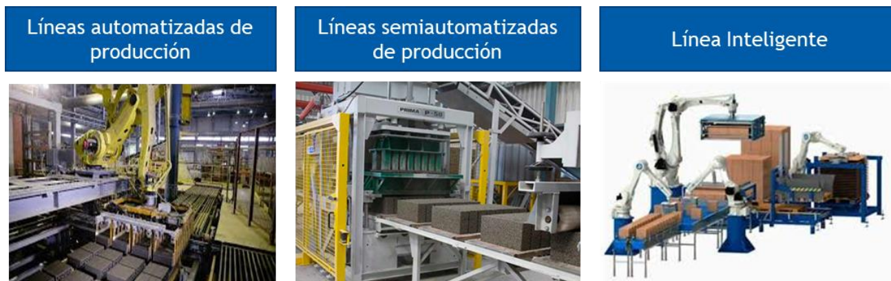
Figura 1-3. Tecnologías de producción actuales para fabricación de ladrillos de arcilla.
