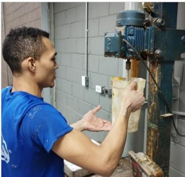
El equipo 2, denominado mezclador químicos II posee un reactor equipado con baffles interior que ayudan al eje mezclador a homogenizar la mezcla de los químicos. Es usado para moldes de 1 metro como medida máxima como lo muestra la *Figura 8*.
