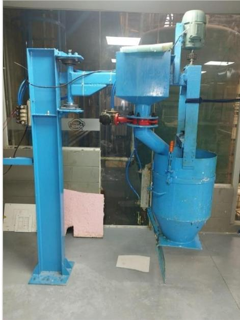
El equipo 3, Campana extractora, se ubica en la parte superior del molde que, al momento de verter la mezcla, desciende manualmente para garantizar extracción de vapores emanados de la reacción química del proceso de formación de las espumas flexibles de poliuretano como se muestra *Figura 9*.
