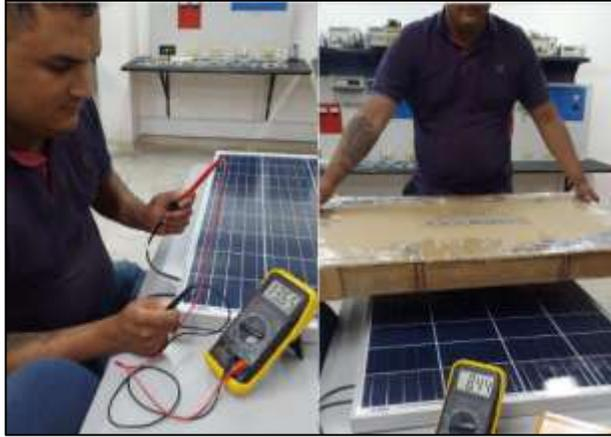
Se realizó la medición de voltaje en el panel solar; se verificó que estaba trabajando correctamente; la prueba consiste en colocar y quitar la iluminación, como se evidencia en la fotografía anterior
