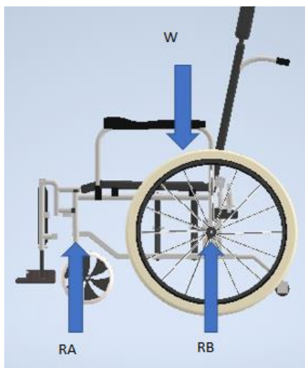
Imagen 27: Silla de ruedas con las reacciones. (Fuente propia)
