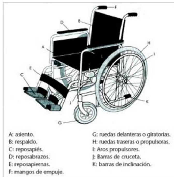
Imagen 11: Partes de la silla de ruedas convencional. [7]
