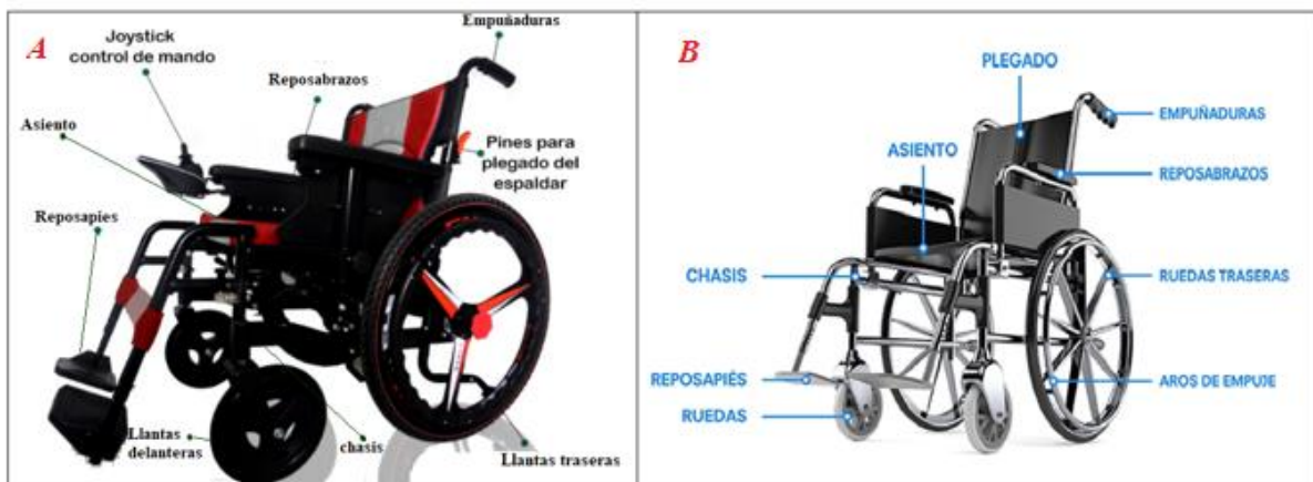
Imagen 24: Partes de las sillas de ruedas, eléctrica (A) y convencional (B). [13]
