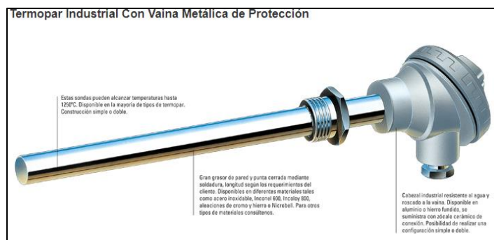
Figura 25. Termocupla Industrial Tipo K [53].
