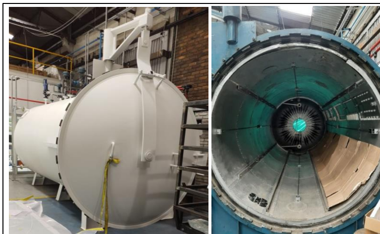
Figura 15. Maquina Autoclave Empresa AGP, Toma Exterior e Interior. Fuente: Autores.
