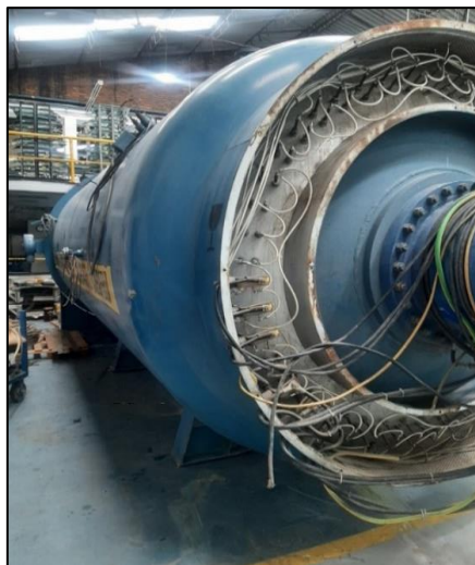
Figura 17. Adecuación de Resistencias de Calentamiento.
