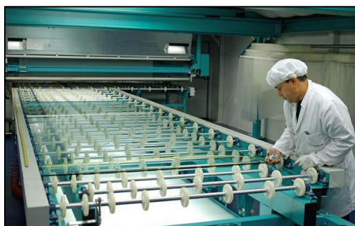
Figura 3. Maquinaria Línea de Producción de Vidrio Laminado [18].
