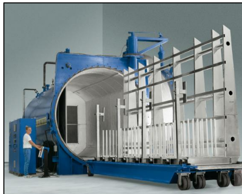
Figura 5. Máquina Autoclave Scholz Maschinenbau [22].
