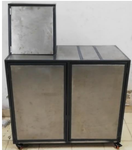
Figura 6-2: Estructura metálica y paneles complementarios banco de pruebas
