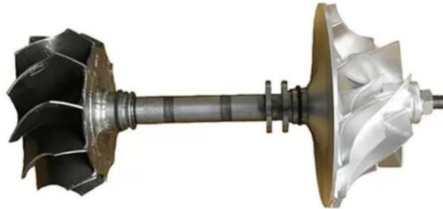
Figura 2-11: Eje de rotor del turbocompresor
