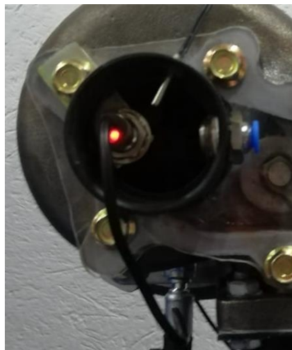
Figura 6-12: Ubicación sensor RPM en turbocompresor.
