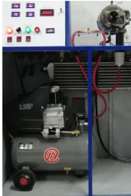
Figura 6-6: Compresor de desplazamiento positivo.
