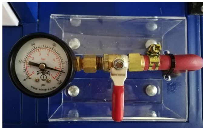
Figura 6-7: Manómetro de presión y válvula de bola.
