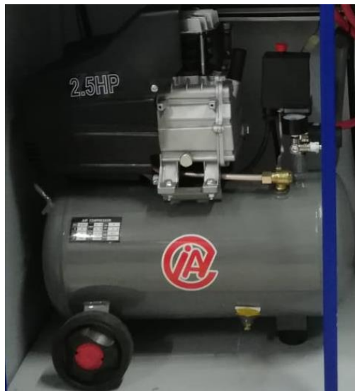
Figura 2-18: Compresor de desplazamiento positivo
