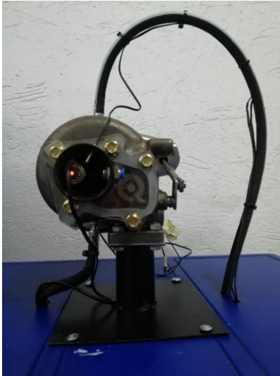
Figura 6-4: Soporte y conexión sistema de presión a entrada gases de escape en turbo compresor
