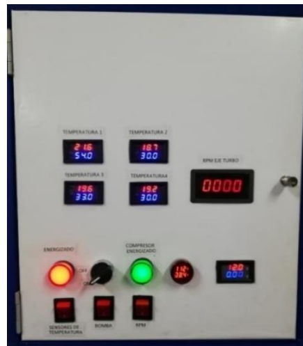
Figura 6-11: Prueba de funcionamiento dispositivos circuito 12 V
