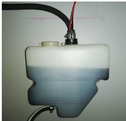
Figura 6-10: Contenedor de aceite y bomba sumergible.
