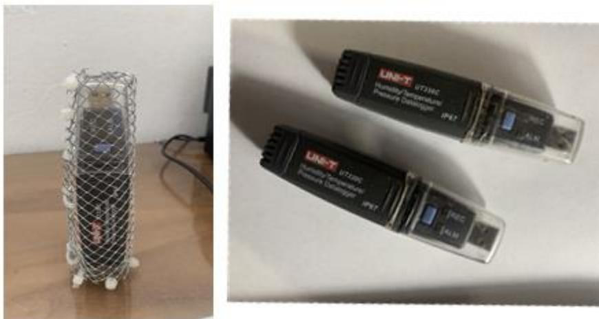
*Figura 17. Datalogger usados para medir temperatura y humedad interna en colmenas.*
