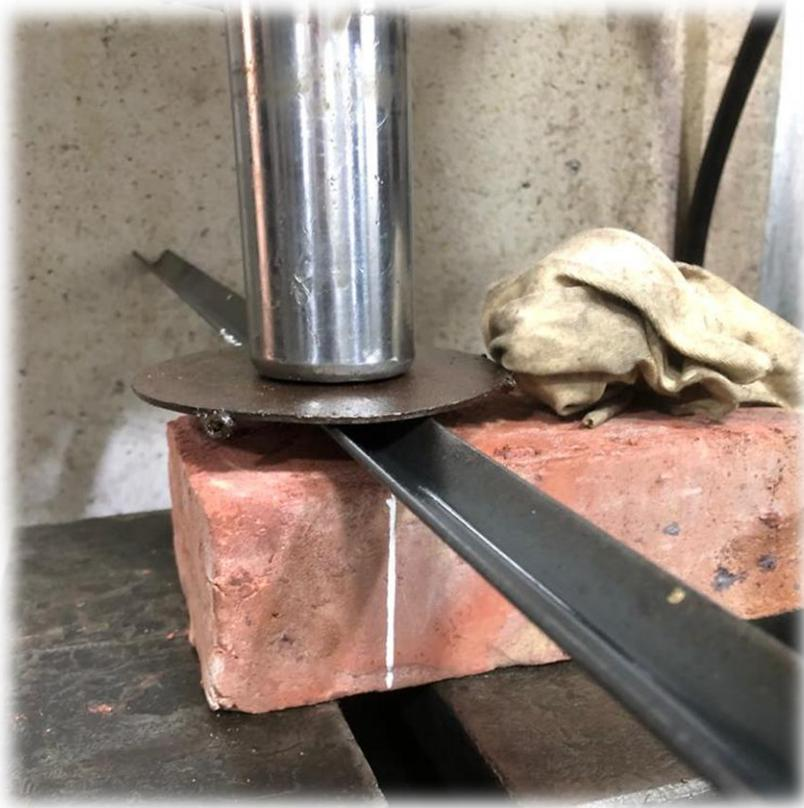
Ilustración 9. ***Prueba de corte del adoquín en prensa hidráulica.*** Fuente: Elaboración propia.
