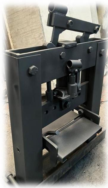
Ilustración 41. ***Ensamble final y pintura.*** Fuente: Elaboración propia.
