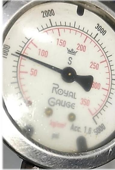
Ilustración 10. ***Presión de corte en manómetro hidráulico (1072 psi)***. Fuente: Elaboración propia.
