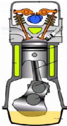
Figura.1 Motor de combustión interna monocilíndrico [3].
