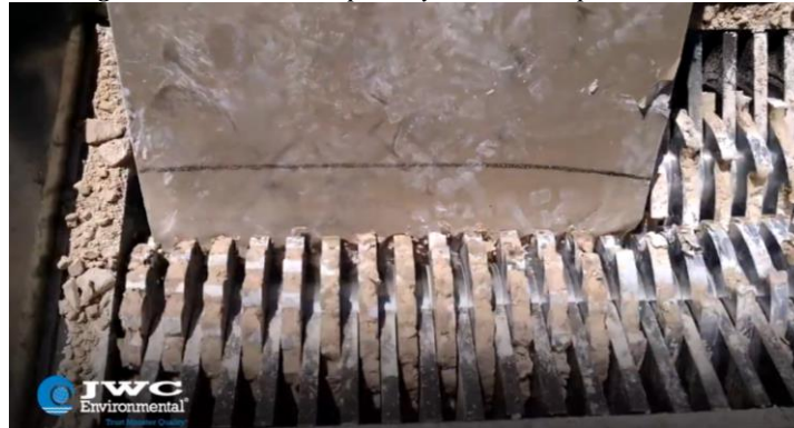
Figura7. Tolva de recepción y trituración por cuchillas.
