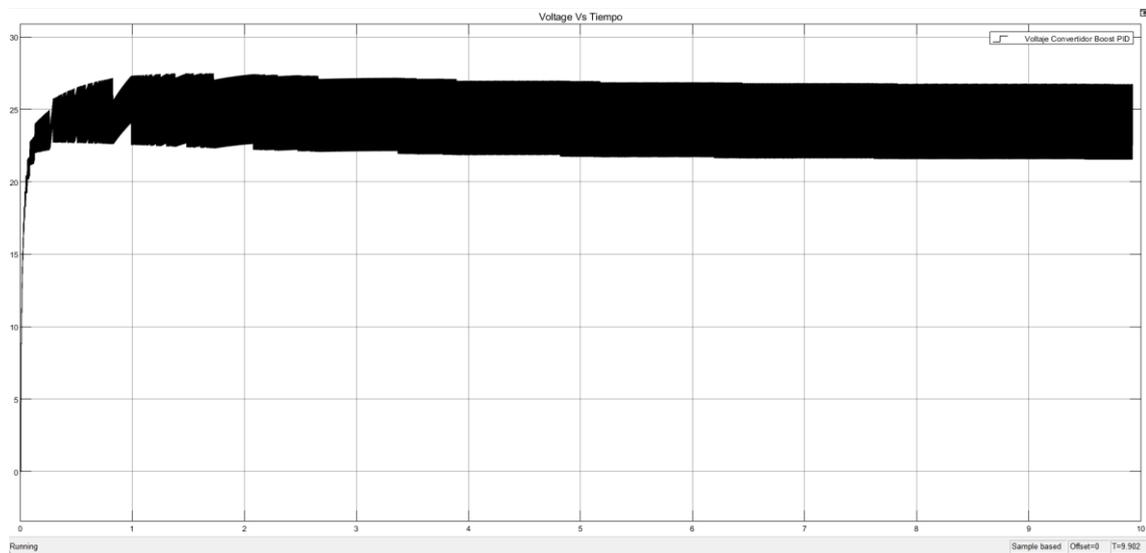
Figura 4-2 Grafica convertidor elevador (Boost) con Control PID entrada 12 V, salida 24. Fuente Propia
