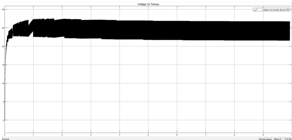
Figura 3-16 Grafica convertidor elevador (Boost) con Control PID entrada 12 V, salida 24. Fuente Propia
