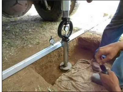
Figura 31. Ensayo CBR. Fuente: (Ramírez & Olano, 2018)
