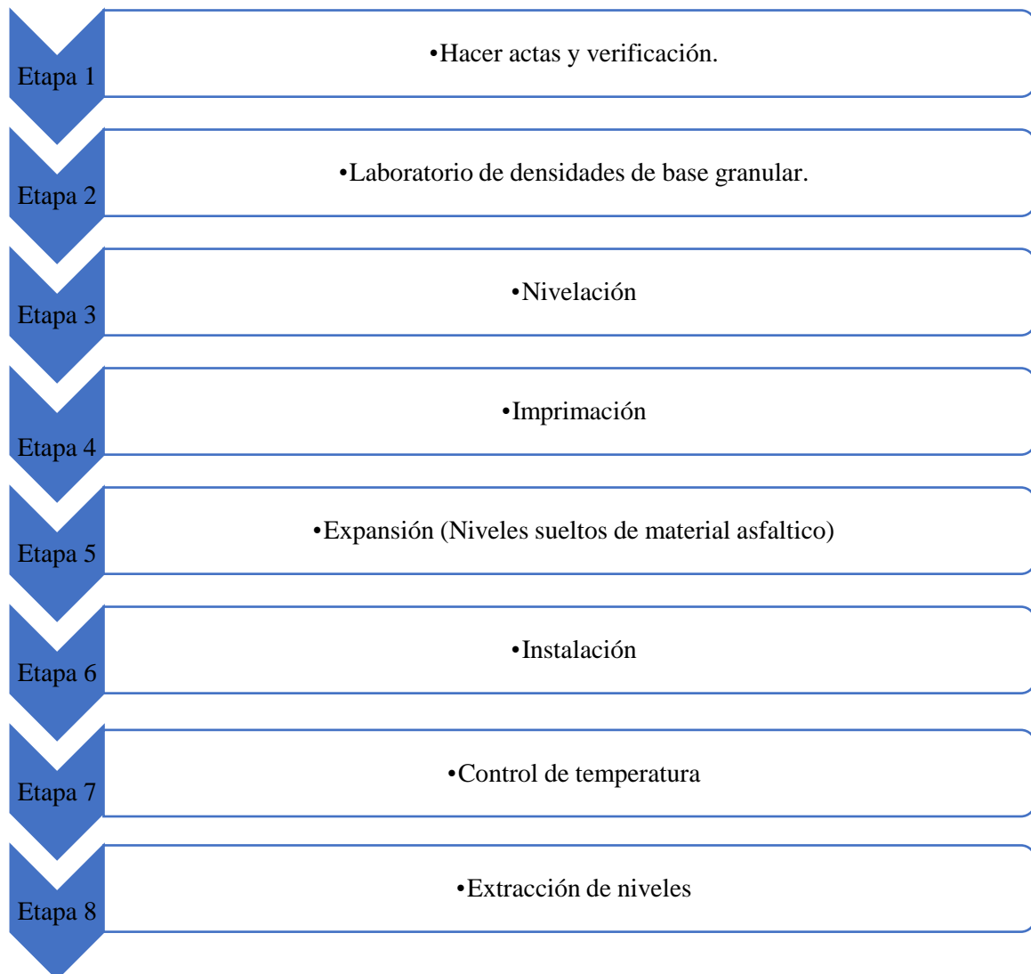
Figura 24. Etapas para la instalación del asfalto. Fuente: Propia
