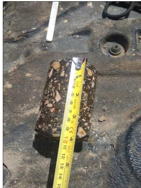
Figura 58. Registro fotográfico de las muestras extraídas con el extractor de núcleos. Fuente: Propia
