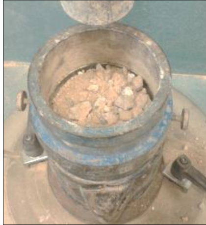
Figura 29. Ensayo Proctor modificado. Fuente:(Murcia, 2016)
