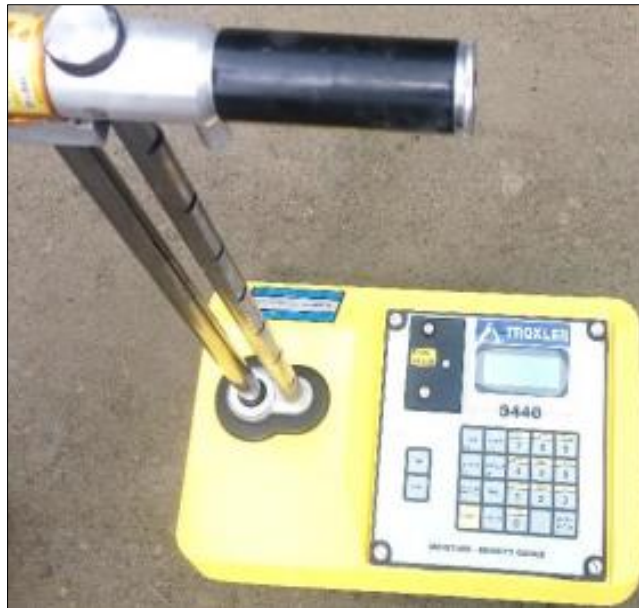
Figura 33. Densímetro nuclear. Fuente: (Cruz, 2020)
