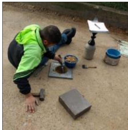
Figura 30. Ensayo de cono realizado de forma in situ. Fuente:(Ortiz, 2017)
