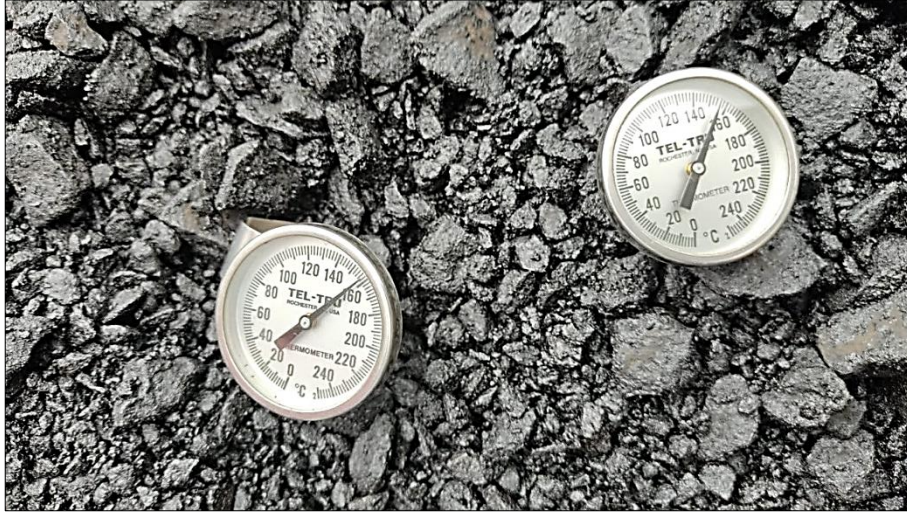
Figura 56. Control de temperatura con dos termómetros de bulbo. Fuente: Propia
