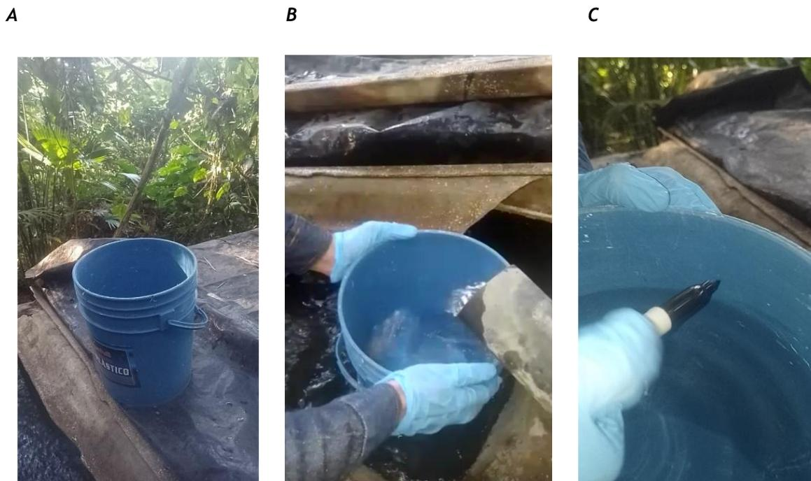
**Fuente:** Elaboración Propia, 2023. **Figura A:** Recipiente para la medida del caudal. **Figura B:** Llenado del recipiente y toma del tiempo que tarda en llenarse. **Figura C:** Toma de la medida total del agua.
