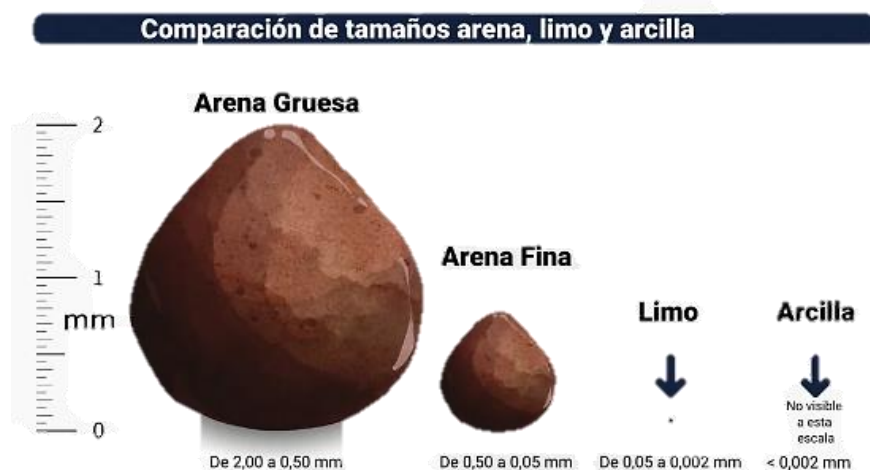
Fig. 2. Comparación de tamaños entre la arena, limo y arcilla [18]
