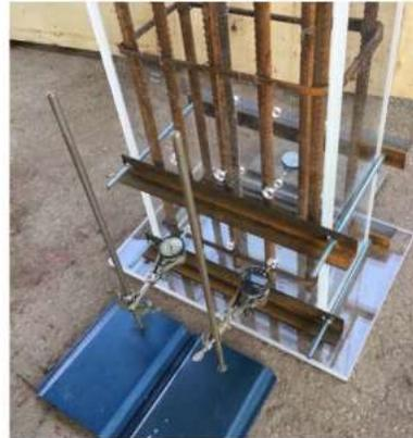
*Grafica15. Presión de SSC sobre acero vertical en encofrados medido con galgas extensiométricas (Construcción, 2017)*
