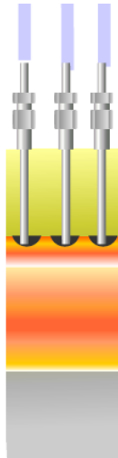
Figura 23. Configuración de los termopares en la interfaz. Fuente: (edibon, 2010)
