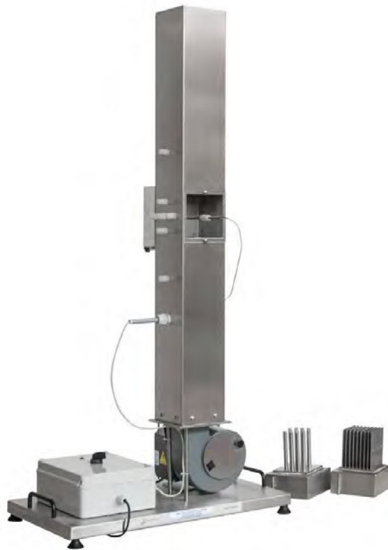
Figura 5. Convección de radiación libre y forzada. Fuente: (Veneta, 2023)
