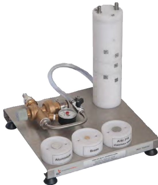
Figura 4. Equipo de conducción lineal. Fuente: (Veneta, 2023)
