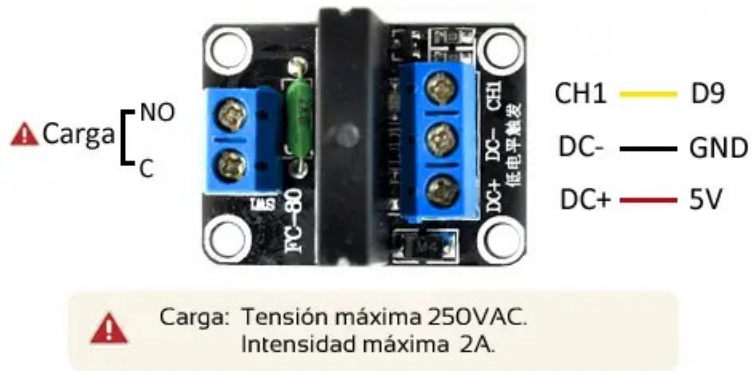
Figura 41. Diagrama de conexión del control relé desde Arduino hasta la resistencia térmica. Fuente: Propia.
