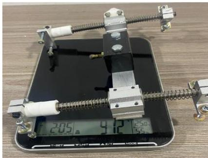
Figura 3.36 Peso real mecanismo leva cilíndrica.
