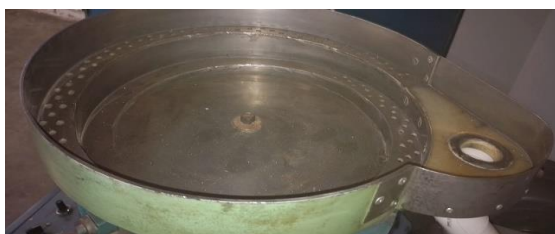
Figura 5-9: Mecanismo vibratorio de alimentación vertical.
