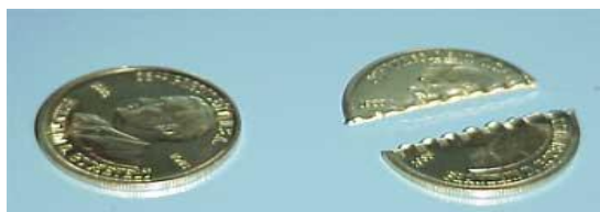
Figura 5-6: dólar canadiense triturado en la maquina Columbia machine.
