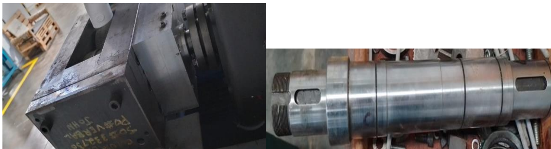
Figura 5-12: Cabezal de trituración y eje central maquina trituradora 1993.
