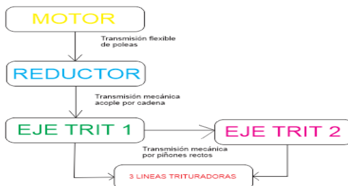
Figura 5-17: Cadena cinemática propuesta de diseño.
