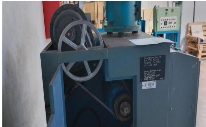
Figura 5-13: Cadena cinemática motor a reductor maquina trituradora 1993.
