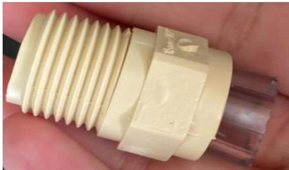
*Figura 11. Rosca tubo de PVC y mangueras de circulación.*
