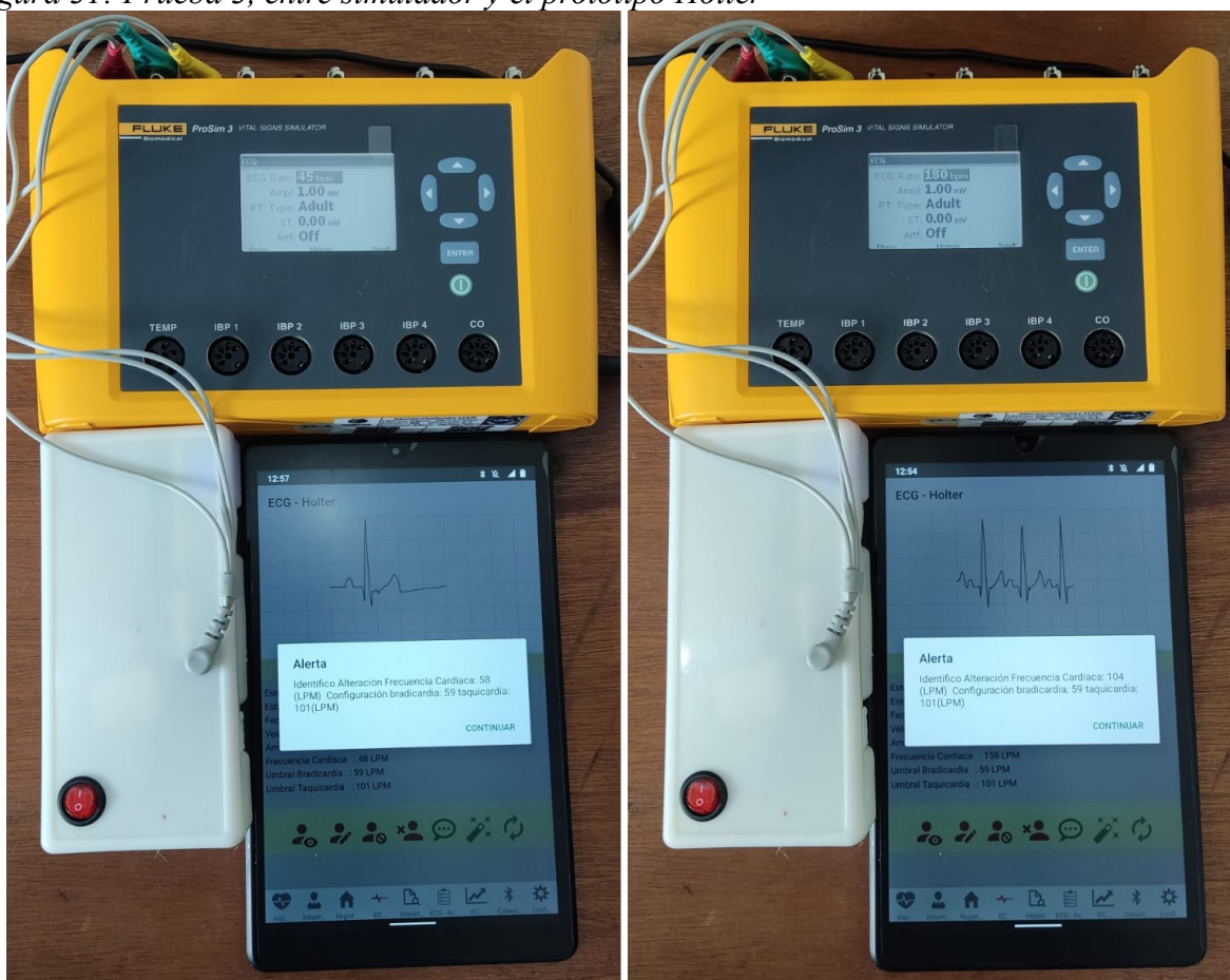
Figura 31: Prueba 3, entre simulador y el prototipo Holter
