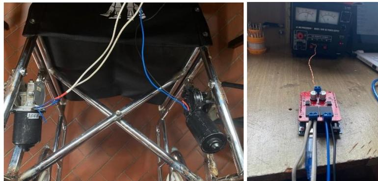
Nota: En la figura 11a se observan los motores ya instalados en la silla y en la figura 11b se observa el controlador de dichos motores.
