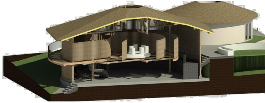
Figura 42. Sistema constructivo corte
