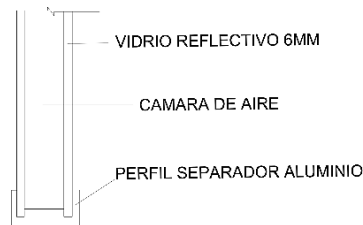
Imagen 51: Detalle vidrio fachadas
