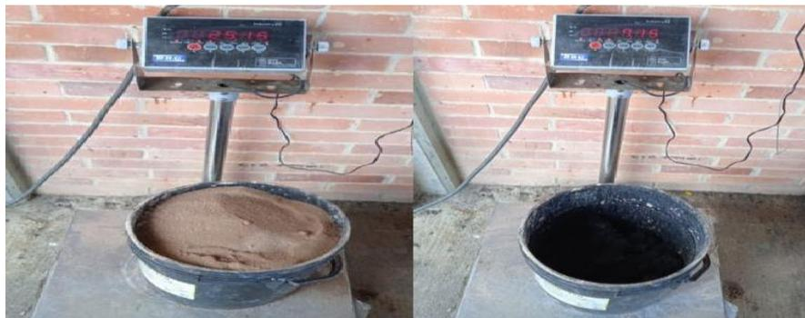
**Ilustración 33-34.** Pesaje de arcilla y lodo residual para ladrillos con porcentaje 80% - 20% con lodo residual PTAP.
