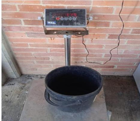
**Ilustración 32.** Pesaje de recipiente para mezclado.
