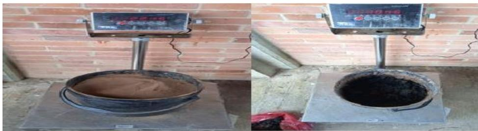
**Ilustración 40-41.** Pesaje de arcilla y lodo residual para ladrillos con porcentaje 70% - 30% con lodo residual PTAR.
