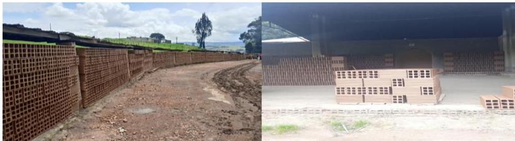
**Ilustración 49-50.** Secado natural de bloques
