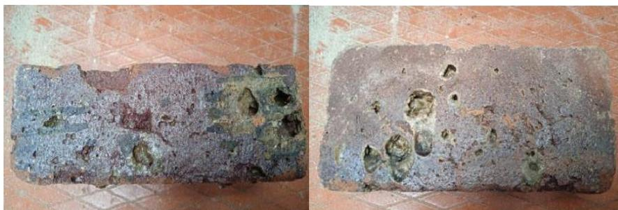
**Ilustración 59-60.** Ladrillos de lodo residual PTAP con huecos.
