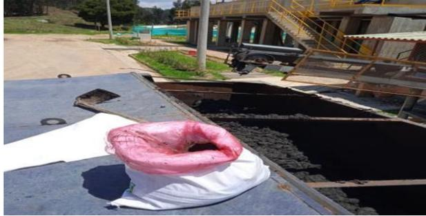
**Ilustración 31.** Toma de muestra de contenedor de lodo residual planta de tratamiento de agua residual PTAR Veolia Tunja.
