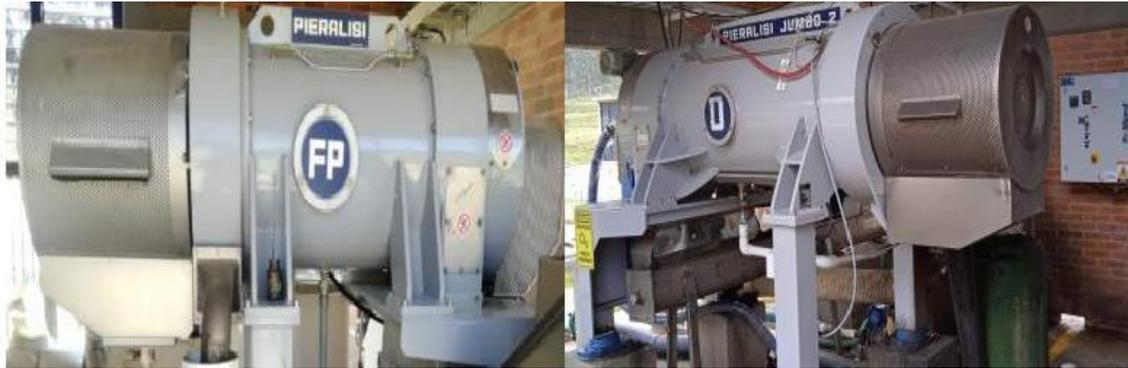
**Ilustración 16-17.** Centrifugadora o decanter PTAR Veolia Tunja.
