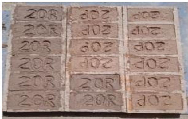
**Ilustración 37.** Ladrillos moldeados 80% de arcilla y 20%
