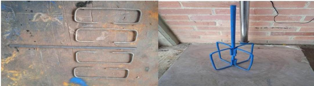
**Ilustración 26-27.** Fabricación de mezclador.
