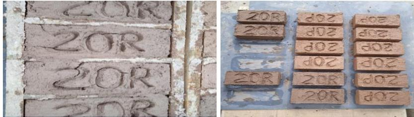
**Ilustración 38-39.** Fisuras en muestras por exceso de humedad y retiro de muestras defectuosas.
