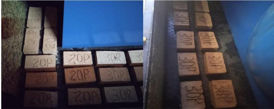
**Ilustración 47-48.** Secado adicional de ladrillos en cabinas de sopladores.
