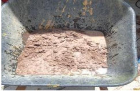
**Ilustración 35.** Mezcla de arcilla con lodo residual PTAP para ladrillos con porcentaje 80% - 20%.
