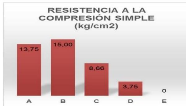
**Figura 64.** Ensayo de resistencia de proyecto “uso de los lodos, producto del tratamiento de aguas residuales, para la fabricación de ladrillos”.
