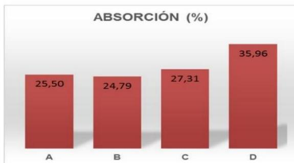
**Figura 61.** Ensayo de absorción trabajo “uso de los lodos, producto del tratamiento de aguas residuales, para la fabricación de ladrillos”.
