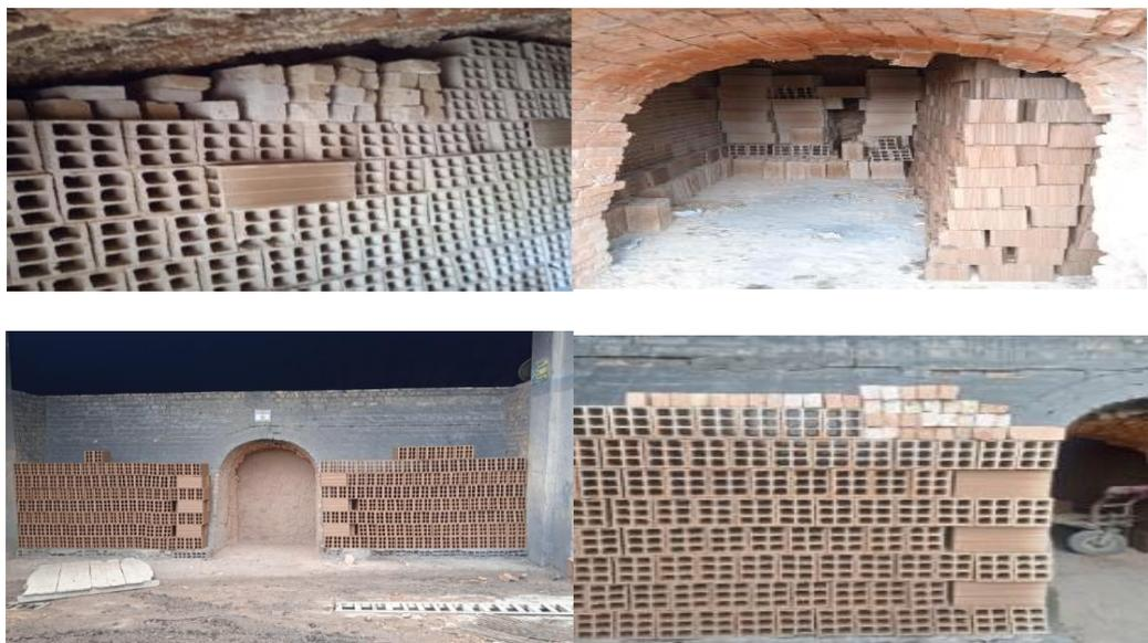
**Ilustración 51-52-53-54.** Proceso de horneado de ladrillos en instalaciones de ladrillera el rubí S.A.S.
