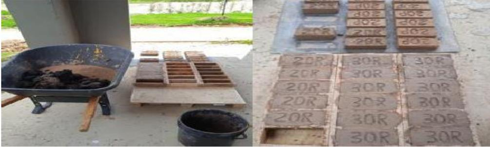
**Ilustración 42-43.** Moldeado y secado de ladrillos 70% de arcilla y 30% lodo residual PTAR.
