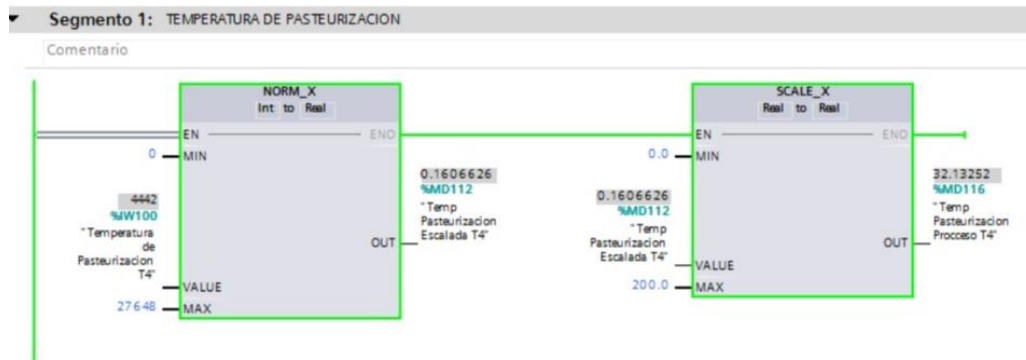
Figura 4- 7: Escalamiento de las entradas análogas sensor de temperatura TT-05
