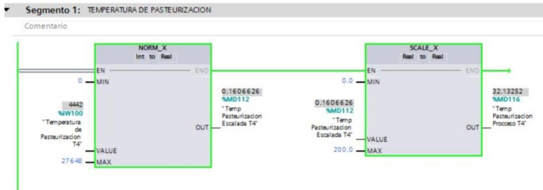
Figura 4- 6: Escalamiento de las entradas análogas sensor de temperatura TT-04
