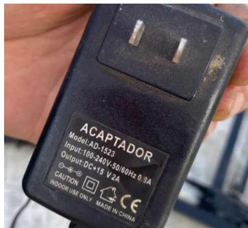
Figura 58. Fuente de alimentación para pruebas del mecanismo
