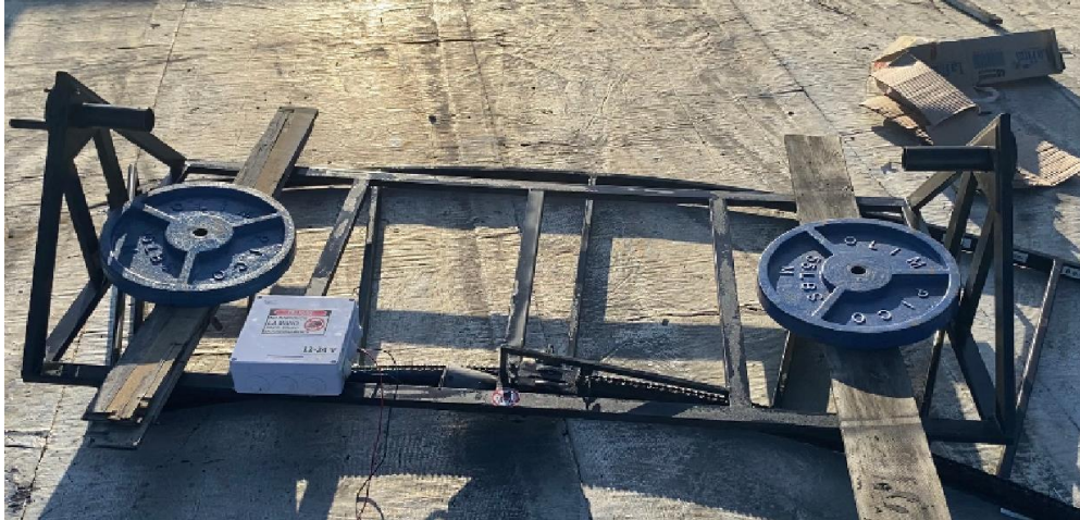
Figura 61. Prueba 2: peso de 110 lb soportado en la base
