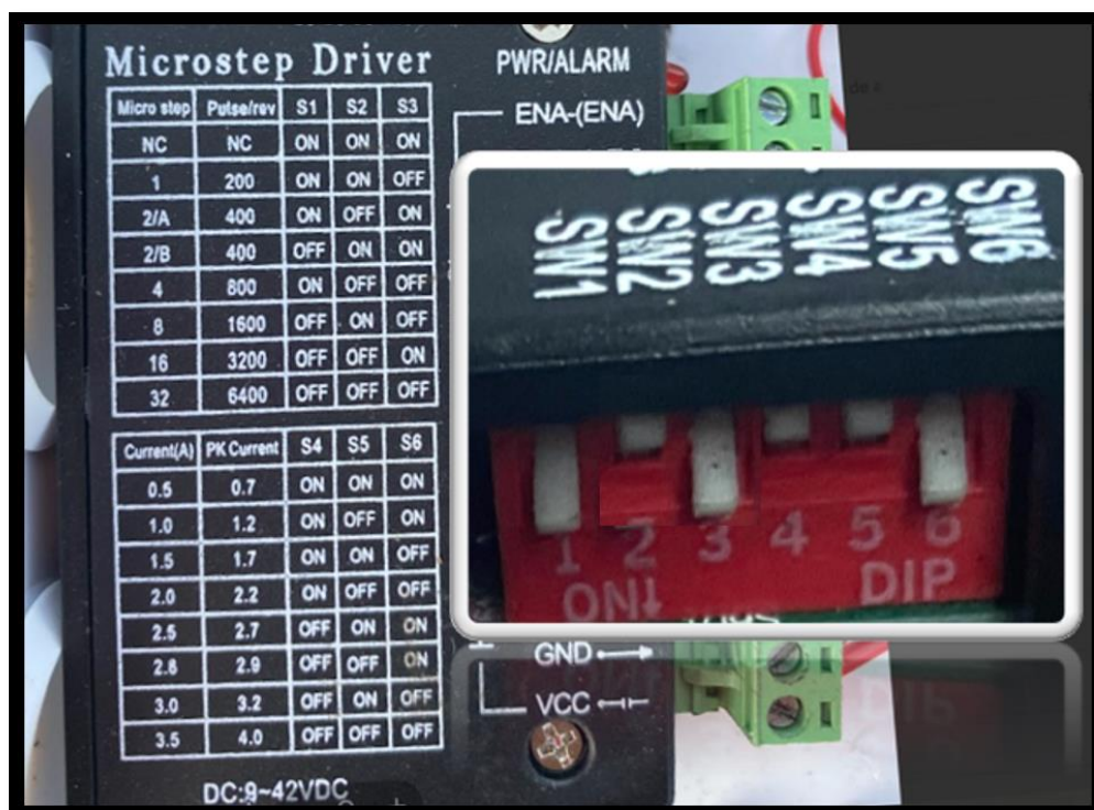
Figura 52. Configuración del controlador del motor paso a paso (autoría propia)
