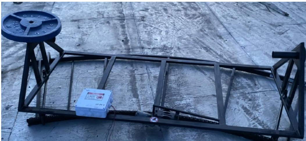
Figura 62. Prueba 2: peso de 55 lb soportado en el eje
