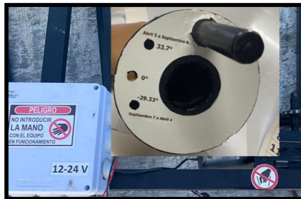
Figura 53. Marquillas operacionales y graduación cenital del mecanismo
