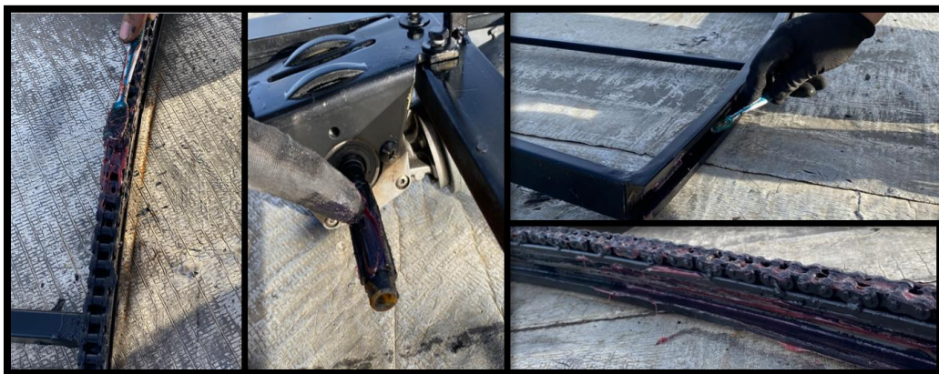
Figura 56. Engrase del sistema de engranaje
