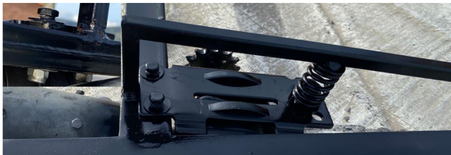
Figura 47. Estructura de anclaje del motor
