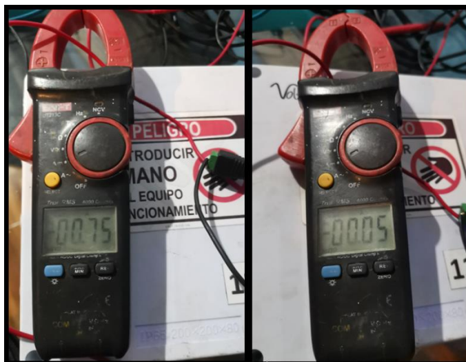
Figura 60. Consumos amperimétricos del sistema de control
