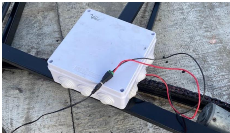
Figura 50. Caja de inspección hermética del sistema de control
