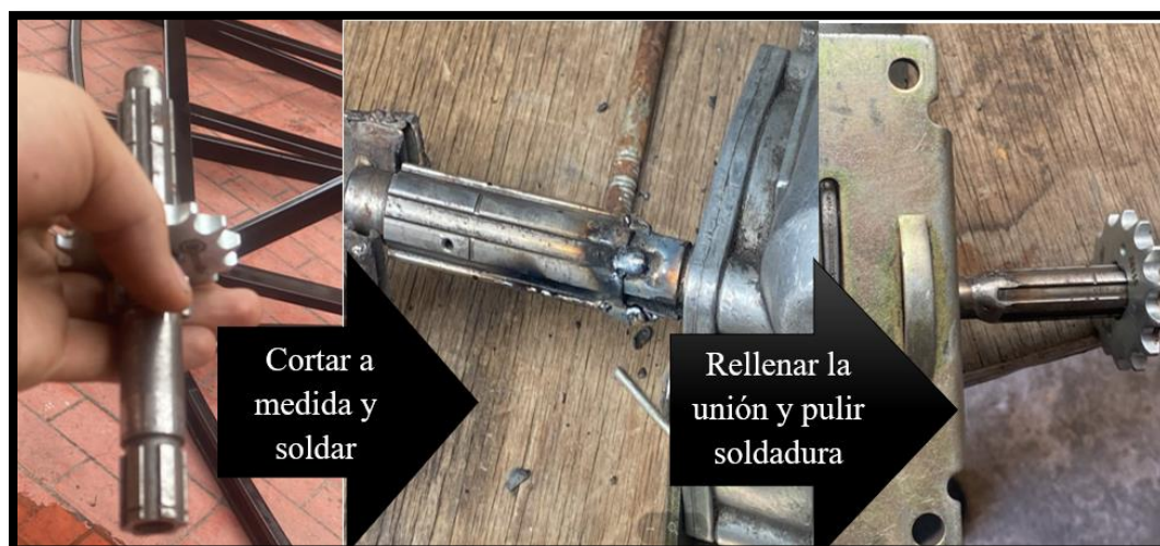
Figura 45. Adecuación del motor al sistema de transmisión
