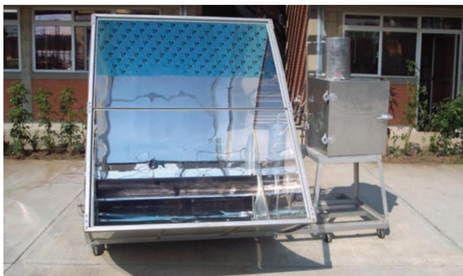
Figura 7. Refrigerador solar por absorción para la producción de hielo (Centro de Investigación en Energía, UNAM). Izquierda: concentrador solar parabólico compuesto; derecha: caja frigorífica.
