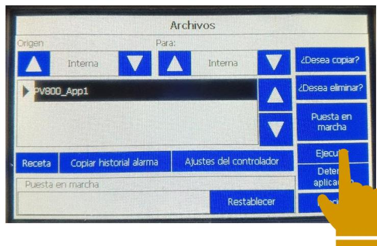
**Tercero.** Después de presionar ejecutar iniciara el programa guardado en el panel debe esperar un momento que cargue el sistema como se muestra en la **Figura 3-3**, que hace referente al sistema de transferencia y llenado.
