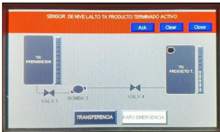
**Séptimo.** Para resolver la falla podemos sacar el agua con un recipiente externo o iniciando el ciclo de transferencia de tanque de producto terminado al tanque de recibo.
