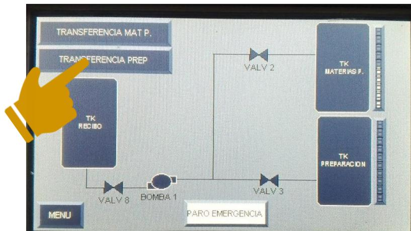
**Tercero.** Al presionar el botón de transferencia automáticamente se encienden las válvulas físicas con nombre VAL 8 y VAL 3 colocándose en color blanco. Pasados 5 segundos enciende la bomba 1 colocando la figura en color blanco e inicia el ciclo de transferencia del tanque recibo al tanque de preparación.
