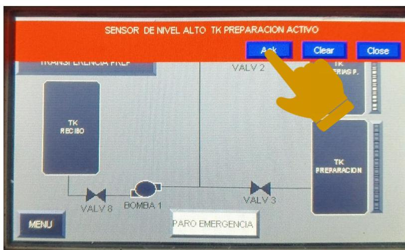
**Noveno.** La transferencia se detendrá por nivel bajo del tanque recibo, cuando el sensor SW-5 pase a su estado 0, quiere decir que no hay líquido en el tanque. Para resolver se debe llenar el tanque de manera externa o transferir del tanque de preparación o tanque de producto terminado.
