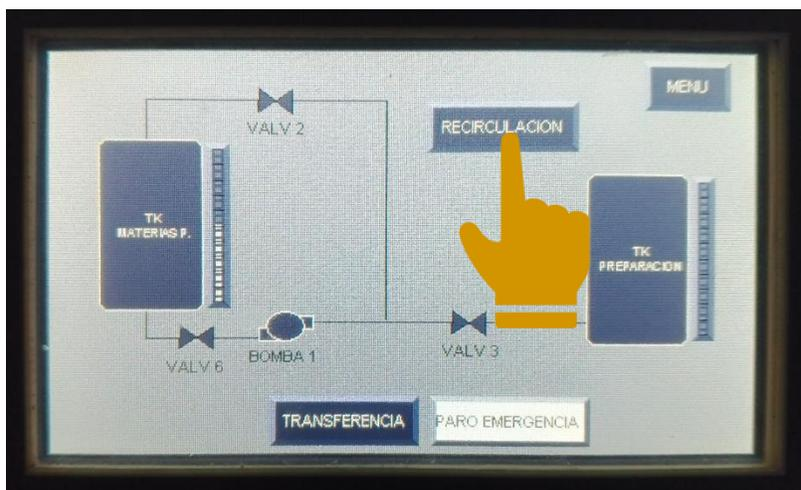
**Tercero.** Al presionar el botón de recirculación automáticamente se encienden las válvulas físicas con nombre VAL 6 y VAL 2 colocándose en color blanco. Pasados 5 segundos enciende la bomba 1 colocando la figura en color blanco.
