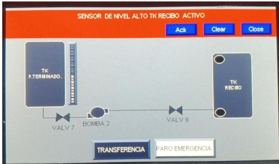
**Séptimo.** Para resolver la falla podemos sacar el agua con un recipiente externo o iniciando el ciclo de transferencia de tanque recibo al tanque de materias primas o ciclo de transferencia de tanque recibo al tanque de preparación.
