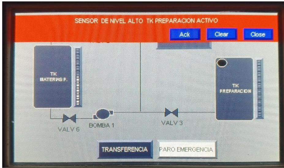
**Séptimo.** Para resolver la falla podemos sacar el agua con un recipiente externo o iniciando el ciclo de transferencia de tanque preparación al tanque de producto terminado.
