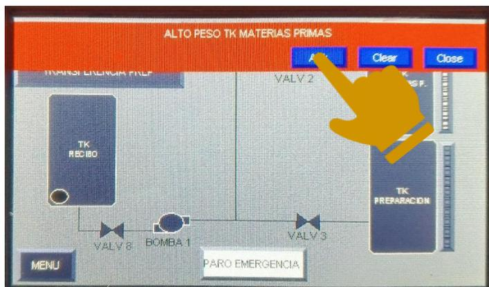
**Duodécimo.** La transferencia se detendrá por nivel bajo del tanque recibo, cuando el sensor SW-5 pase a su estado 0, quiere decir que no hay líquido en el tanque. Para resolver se debe llenar el tanque de manera externa o transferir del tanque de preparación o tanque de producto terminado.
