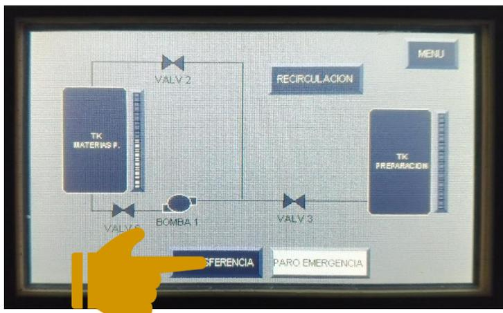
**Tercero.** Al presionar el botón de transferencia automáticamente se encienden las válvulas físicas con nombre VAL 6 y VAL 3 colocándose en color blanco. Pasados 5 segundos enciende la bomba 1 colocando la figura en color blanco e inicia el ciclo de transferencia del tanque de materia prima al tanque de preparación.
