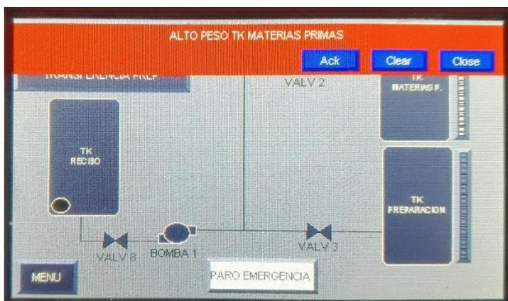
**Décimo.** Para resolver la falla podemos sacar el agua con un recipiente externo o iniciando el ciclo de transferencia de tanque de producto terminado al tanque de recibo.
