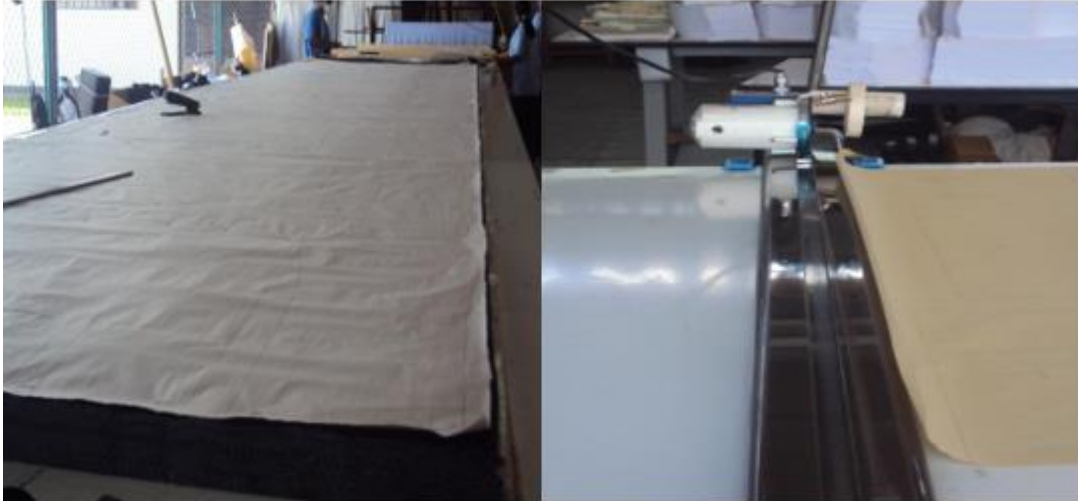
Figura 3 Proceso extendido y corte de la tela
