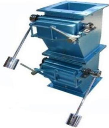
datos de fabricación de válvula pendular doble:
