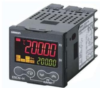
**Nota:** es un mecanismo de control que a través de un lazo de retroalimentación permite regular la velocidad, temperatura, presión y flujo entre otras variables de un proceso en general. El controlador PROplus 1/16 DIN (48 x 48) mm 1 x Salida de relé 2 x Unidad de opción Aux OUT 100-240V AC.
