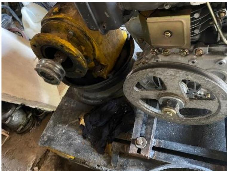
**Nota:** La función es interconectar por medio de una correa con el motor y con el medio donde se hace la transmisión de energía
