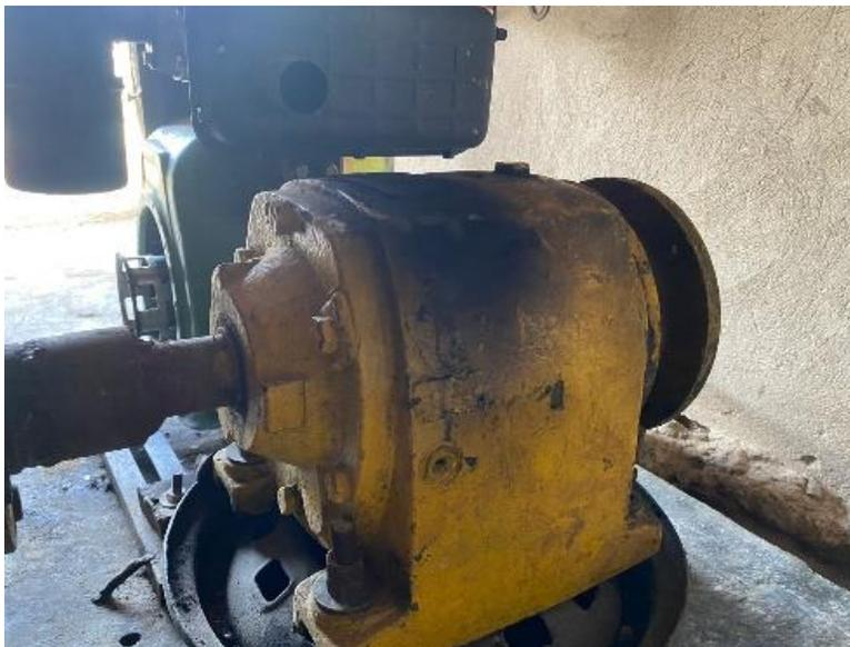
**Nota:** La función en el sistema es reducir la velocidad generada por el motor
