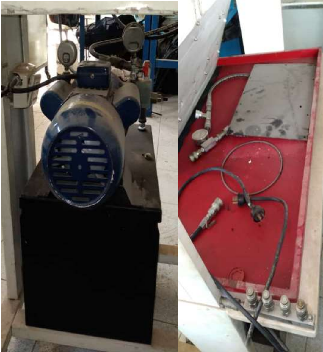
Motor eléctrico, depósito de aceite hidráulico y conectores de las líneas para retorno del aceite
