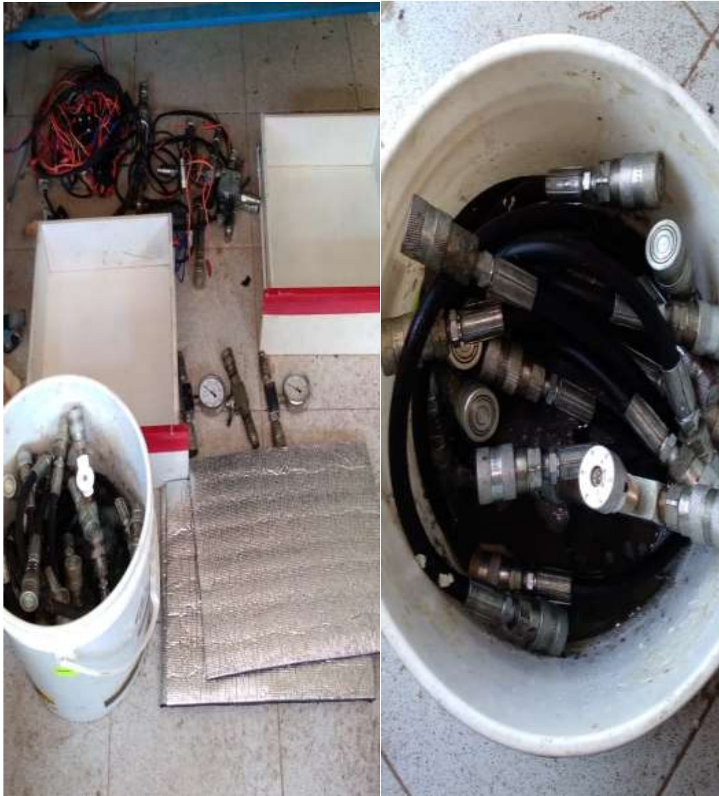
Lavado de mangueras hidráulicas y limpieza de las otras piezas
