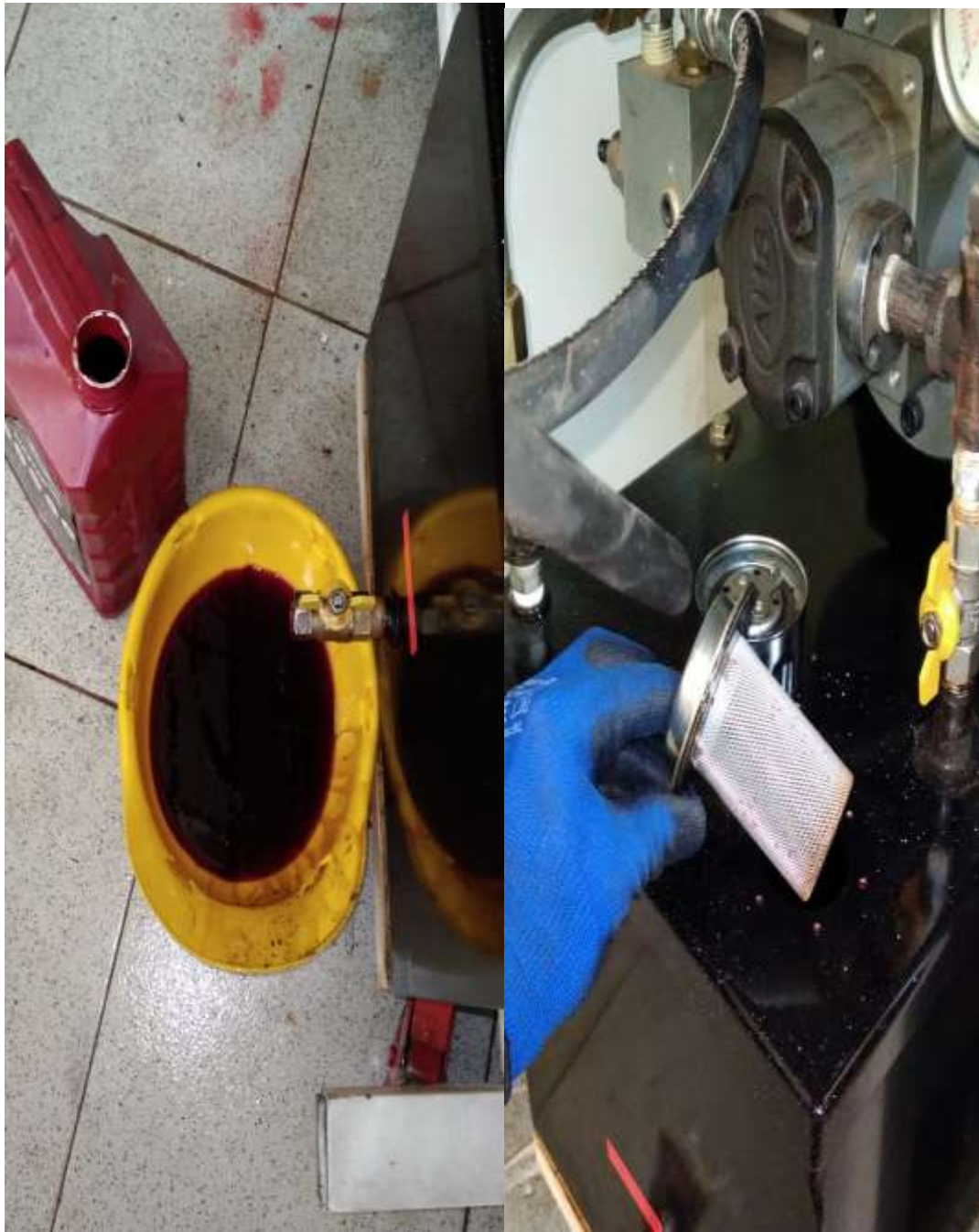
Drenaje del aceite hidráulico y limpieza del filtro
