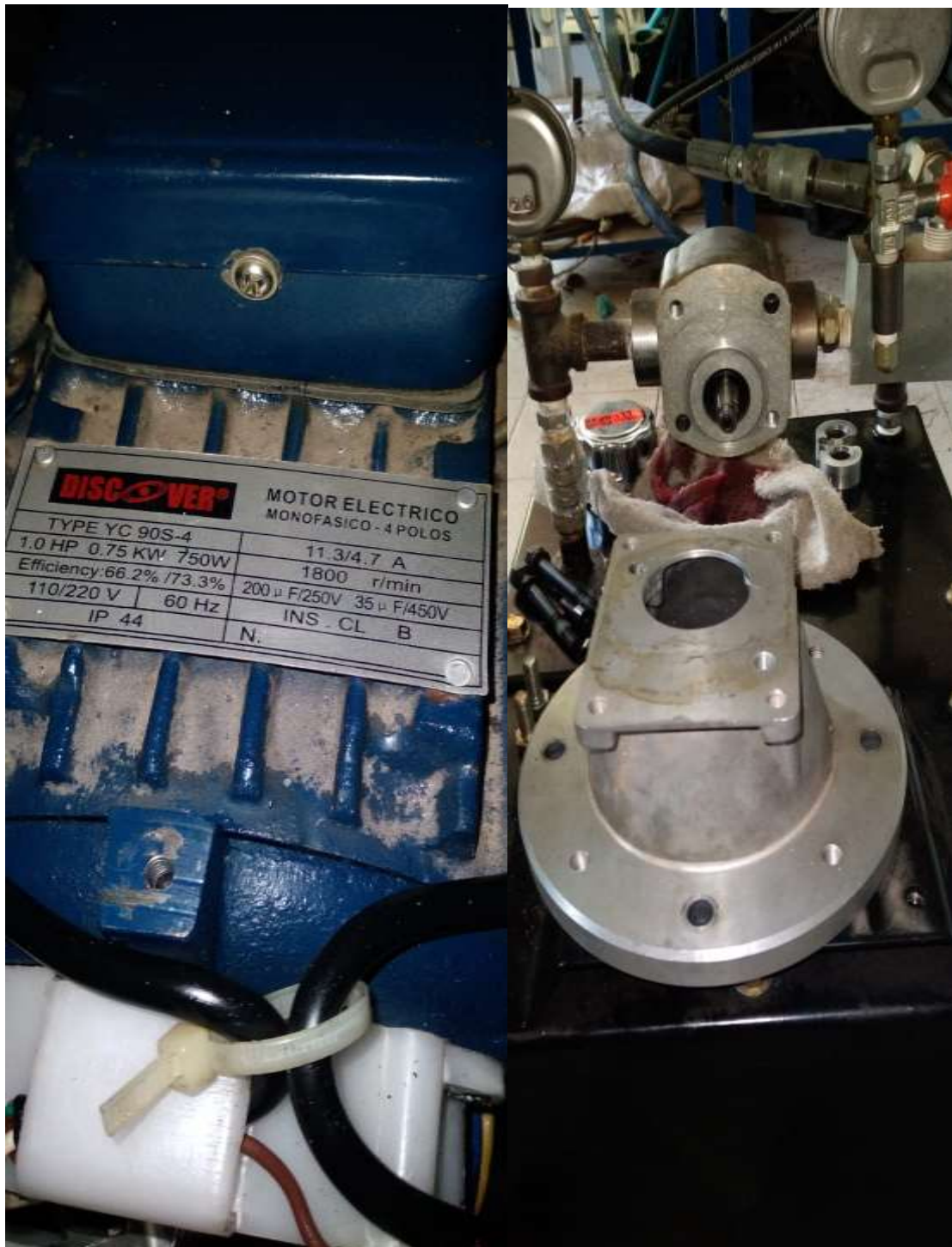
Lado izquierdo plaqueta de identificación del motor eléctrico y lado derecho empieza desarme de bomba hidráulica
