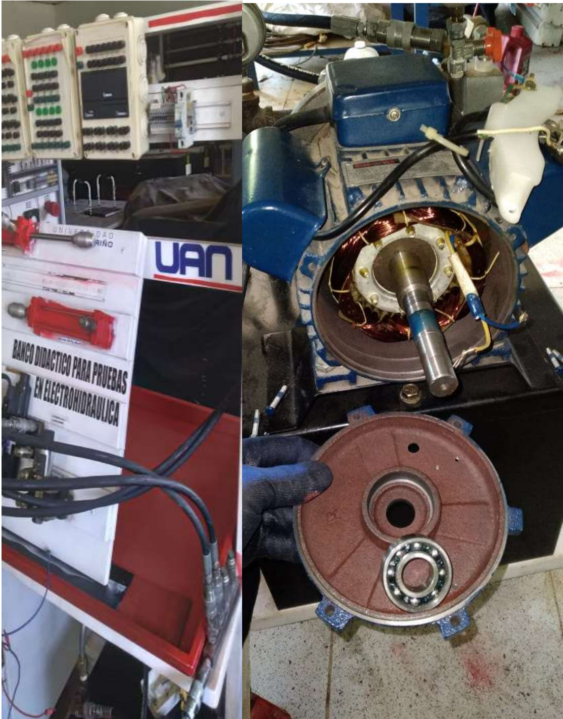
Lado izquierdo puesta de identificación del banco y lado derecho revisión de rodamiento del motor eléctrico
