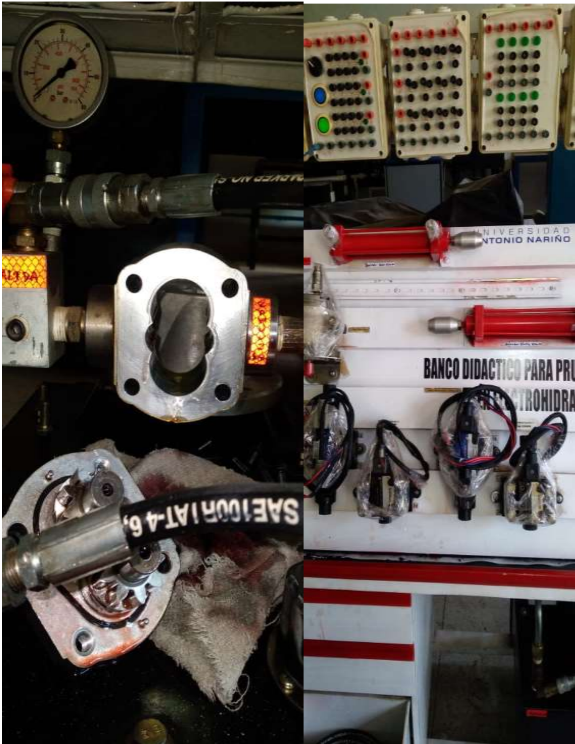
Lado izquierdo desarme bomba hidráulica y lado derecho preservación de componentes y accesorios del banco hidráulico
