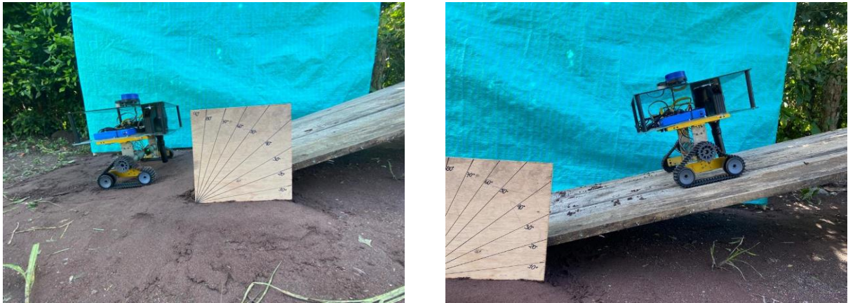
Figura 30. Robot prueba de inclinación a 20^\circ
