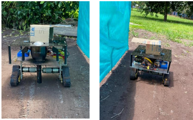
Figura 48. Robot con la cubierta diseñada para porteger el Lidar
