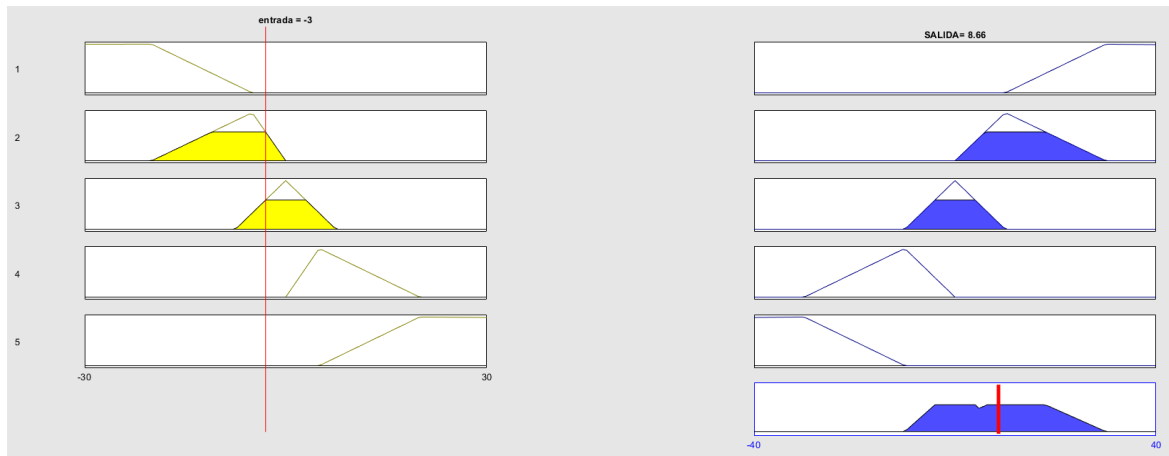
Figura 25. Control difuso, error de orientación -3^\circ .
