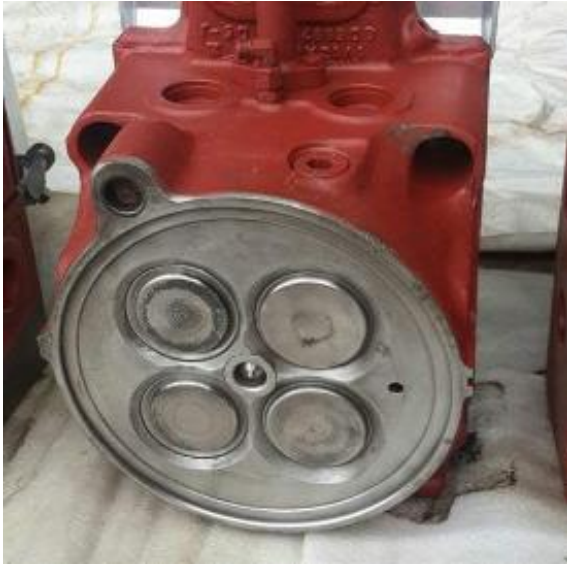
Imagen 5. Fuente propia. Culata de un motor con GLP.
