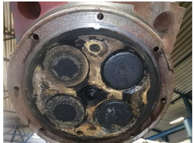
Imagen 3. Fuente propia. Culata del motor,
