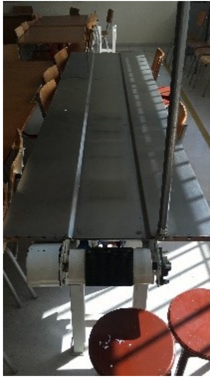
Figura 1-2: Banda Transportadora de Cinta desarmada. Fuente: Autor.
