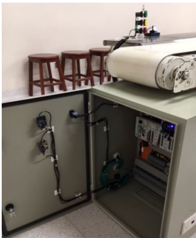
Figura 4-2: Implementación Panel de Control. Fuente: Autor.
