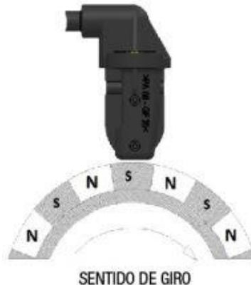
Figura 21. ABS hall con anillo codificador magnético
