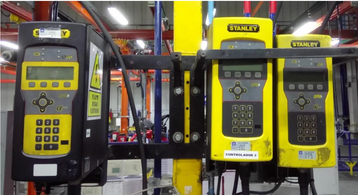
Figura 42. Controladores de torque (Stanley)
