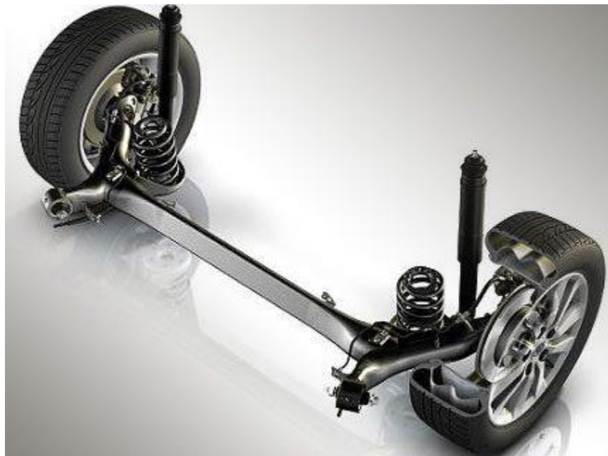
Figura 8. Suspensión de eje rígido de un automóvil
