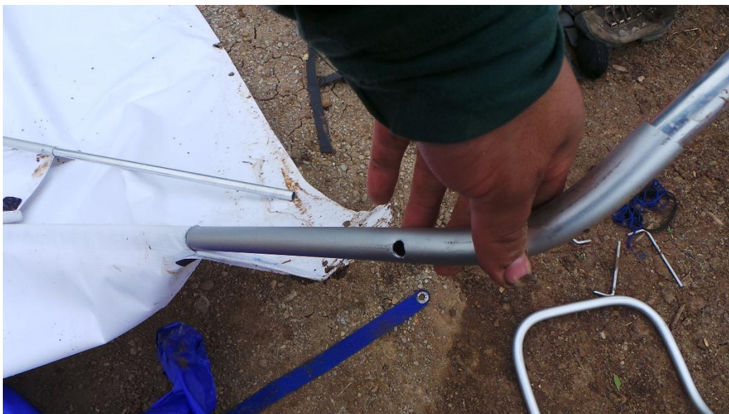
Fotografía 29. Ensamble parales a lona. Fuente propia
