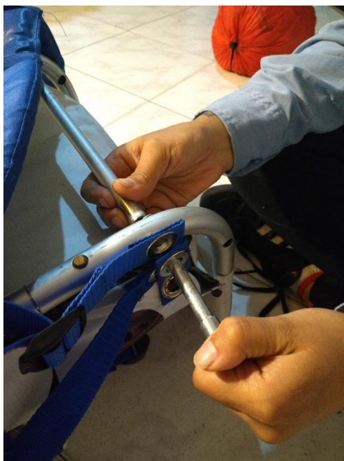
Fotografía 42. Colocación de pines.
