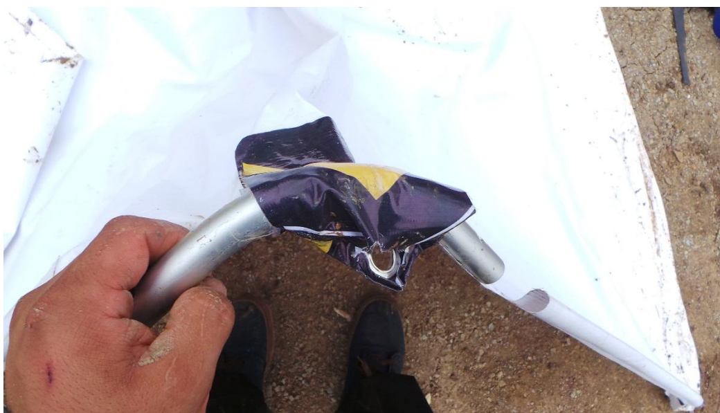
Fotografía 28. Ensamble de arista triangulo a lona. Fuente propia
