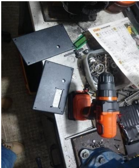
Figura 4- 21 Caras protectoras de circuitos
