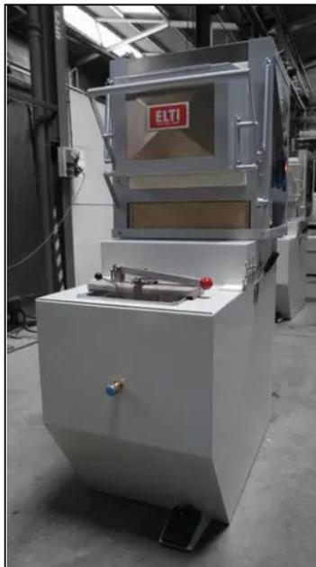
Fuente: Tomado de ([Máquina de prueba de templabilidad - EASYLAB JOMINY - HEAT CONCEPT - digital / de acero inoxidable \(directindustry.es\)](#)).
