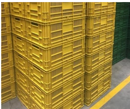
Figura 5. Canastilla de plástico con pasillos apilados al suelo y demarcados a 1 metro entre arrume
