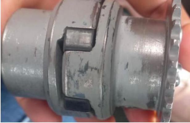
Fig. 14. Pieza mecánica restaurada, acople motor-eje de torsión.
