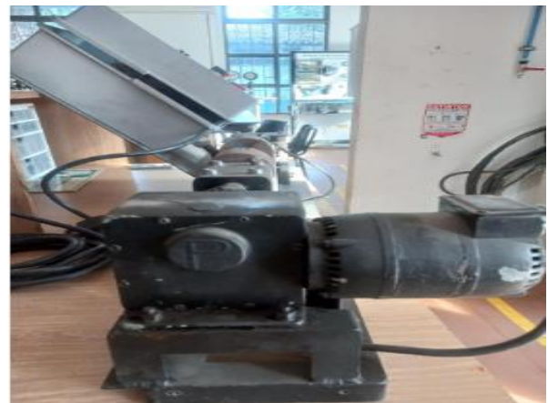
Fig. 5. Motor trifásico, componente del banco de pruebas de ensayos a torsión
