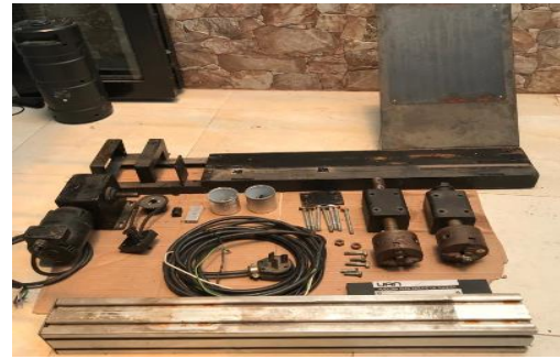
Fig. 12. Desmontaje de piezas mecánicas del banco.
