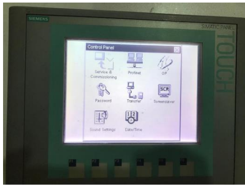
Fig. 18. Programación de la HMI Siemens SIMATIC KTP600 Basic Mono PN.
