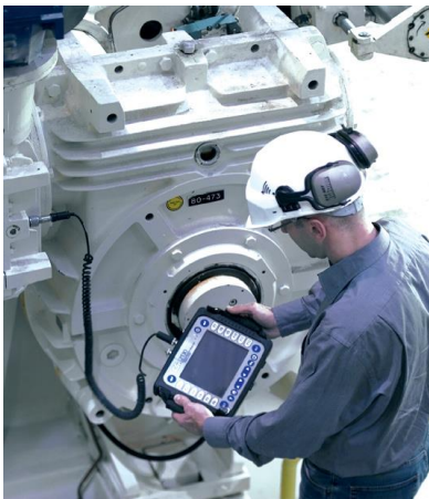
Fig. 1. Recopilación de datos, mantenimiento basado en condición-mecánica.
