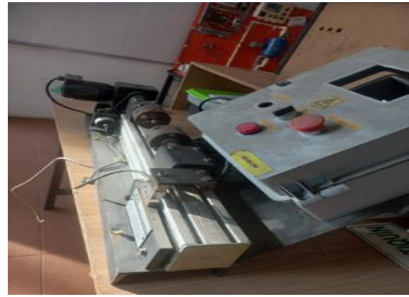
Fig. 4. Banco de pruebas de ensayos a torsión ubicado en el laboratorio de electromecánica de la universidad Antonio Nariño-Sede Villavicencio.
