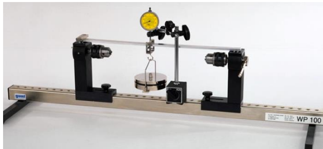
Figura 11. Deformación de barras por flexión o torsión.
