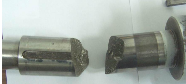
Figura 4. Torsión de ejes.
