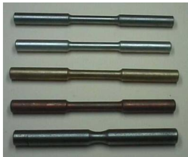
Figura 12. Probetas de ensayo de tracción para tipos de materiales.
