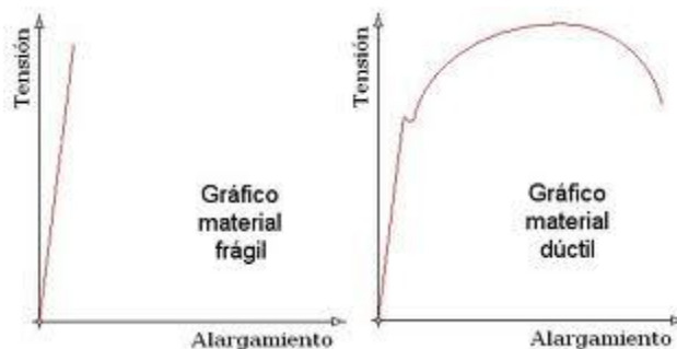
Figura 13. Deformación unitaria para materiales dúctiles y frágiles.
