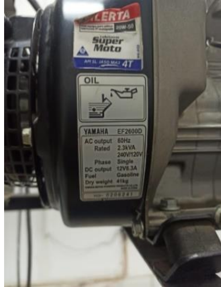
Figura 11 – Características del motor de combustión interna
