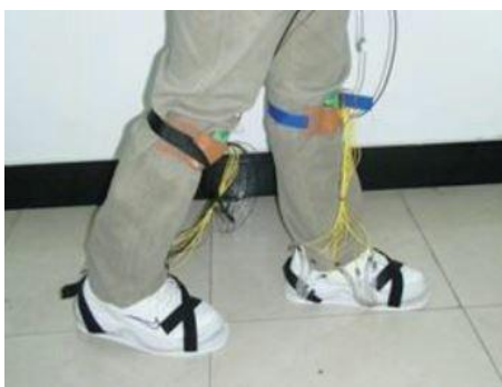
Figura 1-5.: Sistema de presión plantar implementado por [25]
