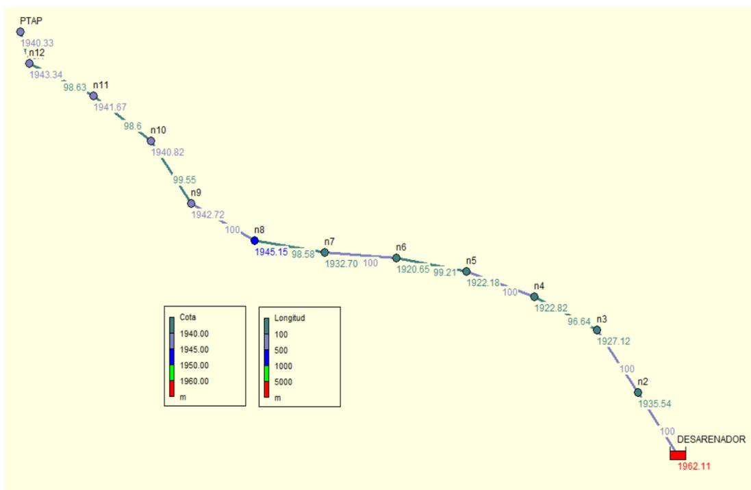
*Nota. Fuente:* elaboración propia, modelación hidráulica en software EPANET 2.
