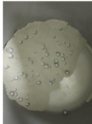
**Nota:** se observan las revoluciones usadas para el ensayo del Micro-Deval y como queda el tambor después del ensayo
