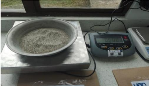
b. *Pesaje de la carga abrasiva utilizada.*
