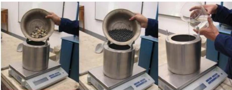
**Nota:** Introducción al recipiente cilíndrico la muestra, carga abrasiva y agua (INVIAS, 2012).
