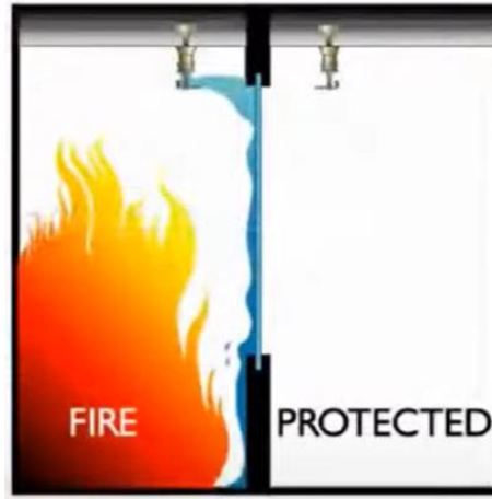
Figura 4-20. Funcionamiento de un rociador de ventana.
