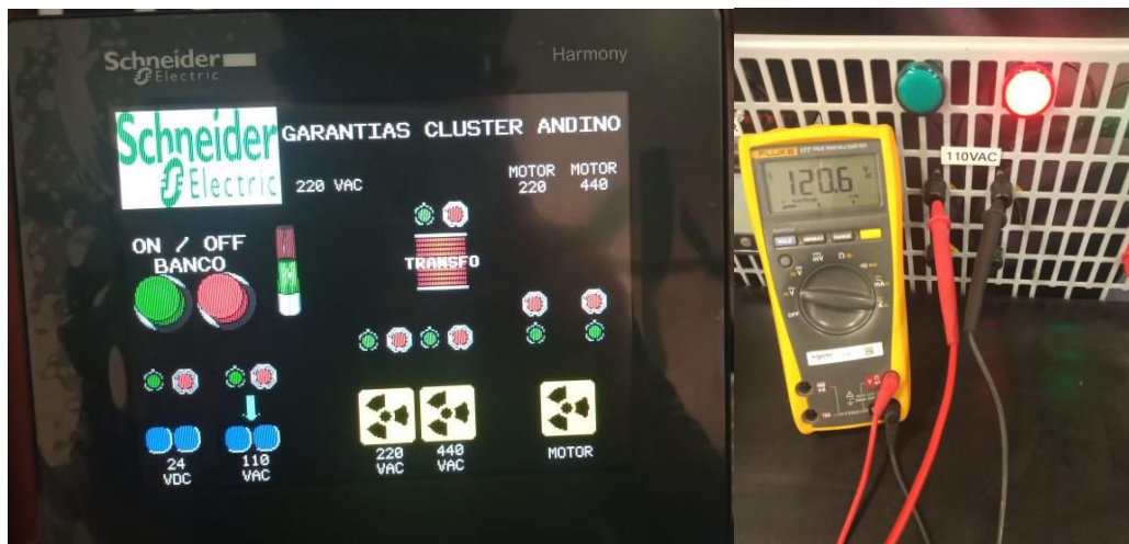
Figura 23. Activación circuito 120 VAC monofásico.
