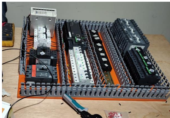
Figura 14. Distribución equipos para tablero eléctrico.
